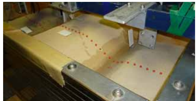
写真-2 Case3の実験後(盛土の沈下と周辺の隆起)
