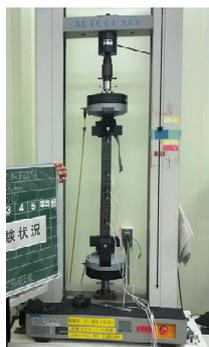
写真-2 引張試験概要
