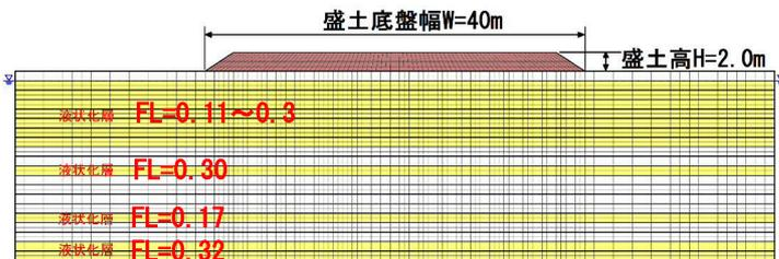
ALIDによる変形照査断面
