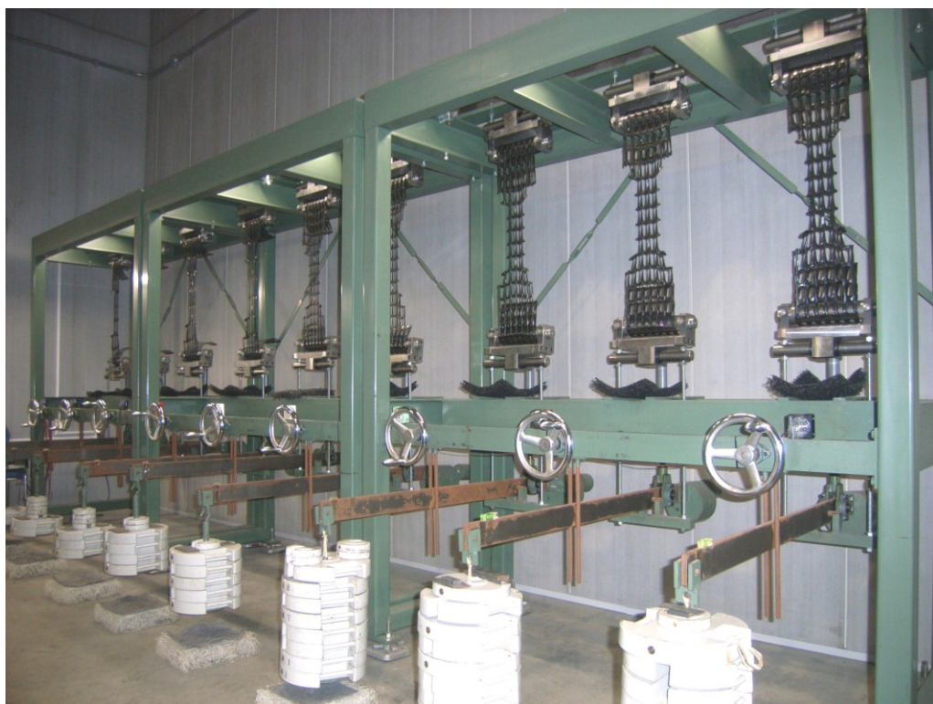
写真 4.1 クリープ試験状況
